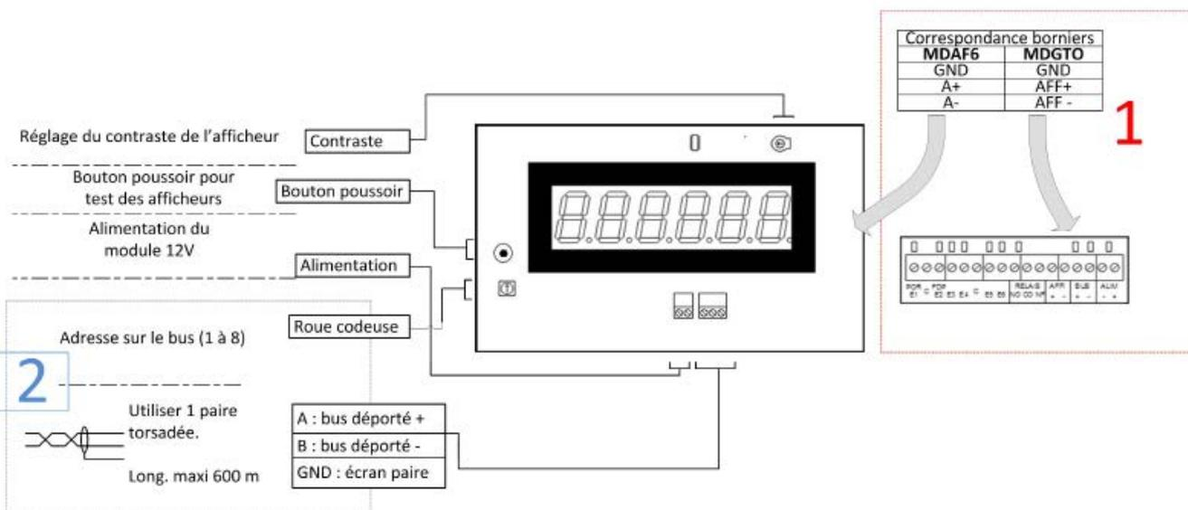
**1** : Dans le cas d'un raccordement sur un module MDGTO
